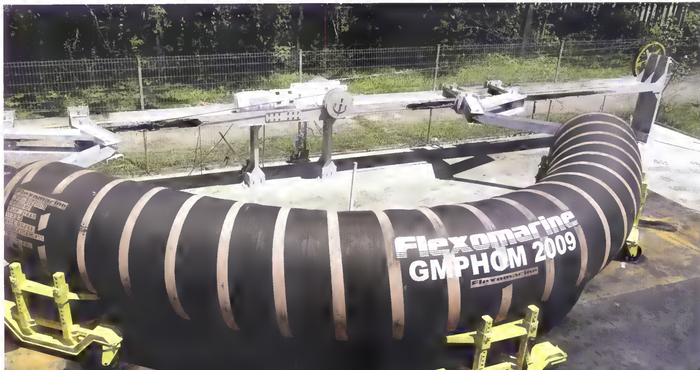
Ensaio de fadiga em um mangote, usado para conduzir petróleo nas transferências do produto entre navios e plataformas de produção
