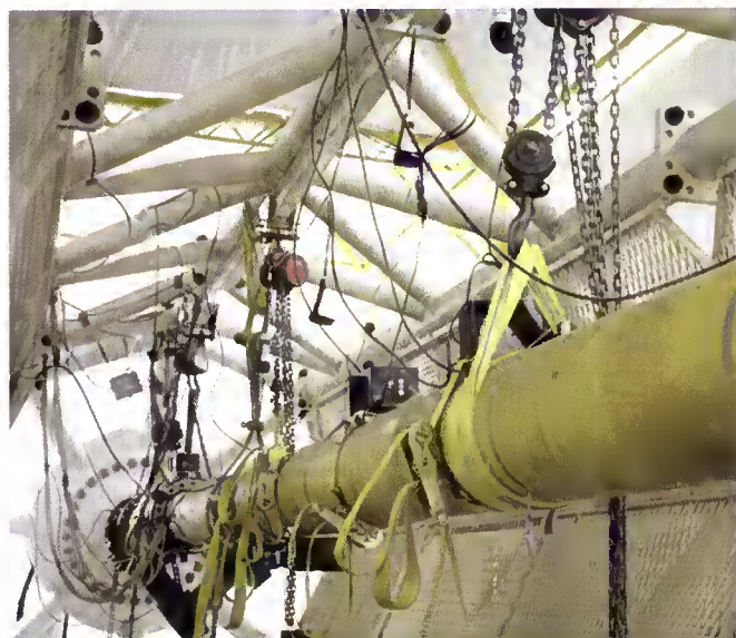
Acima, segmento de riser flexível sendo ensaiado em fadiga, com cargas entre 50 e 350 toneladas. Abaixo, parte de um sistema de ensaios, onde atuador permite aplicar cargas de até 600 toneladas com deslocamento de 2,5m
